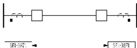
图 2. 简单的双端差动保护
